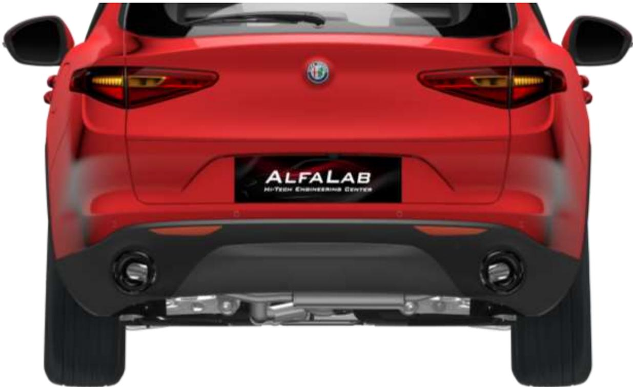
Les feux arrière ne présentent aucune ampoule. Ils sont équipés de leds, type full led. Les feux arrière comprennent une partie fixe et une partie mobile.
