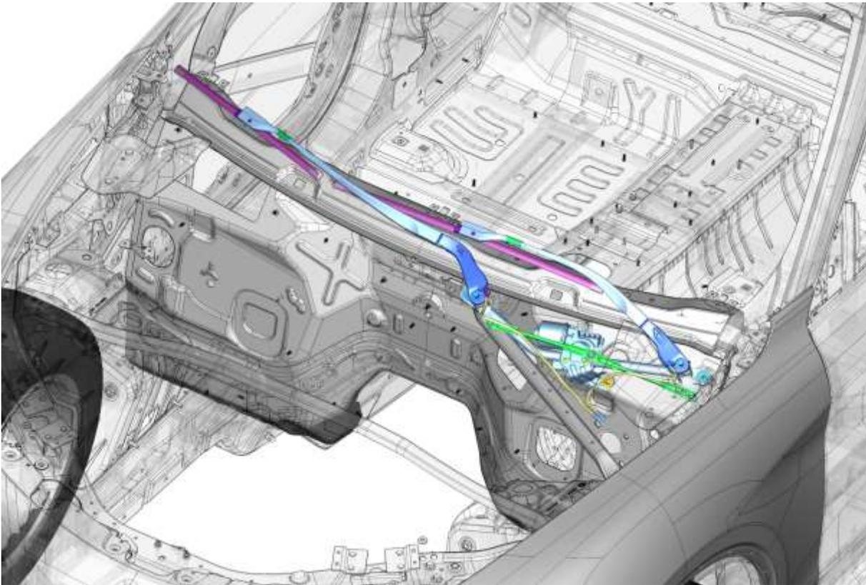
Le mécanisme d'essuie-glace comprend un moteur électrique type LIN qui actionne une tringle de commande des deux bras aux extrémités desquels sont fixés les balais.
