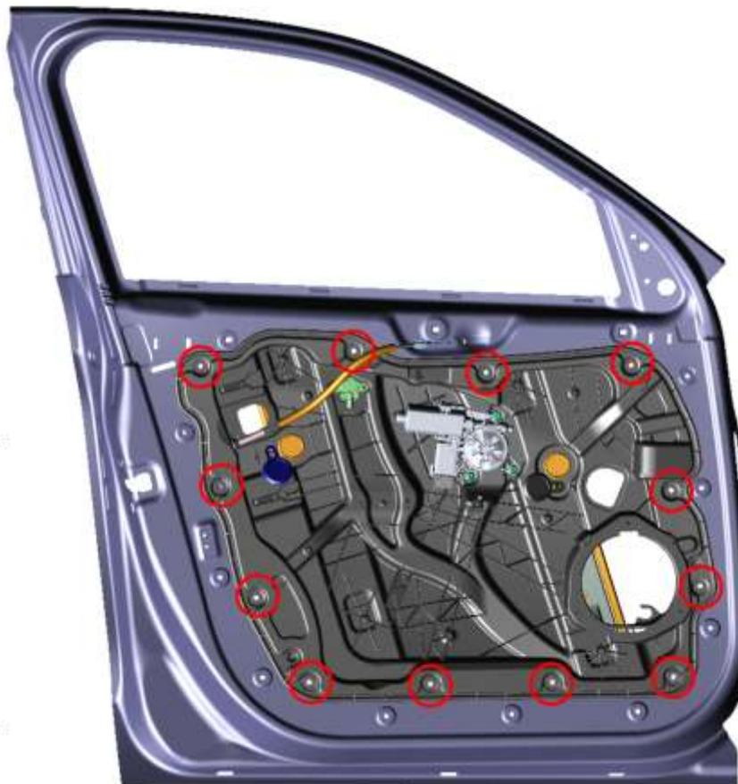
Les cercles rouges sur la figure indiquent les points de fixation du support sur la porte.
